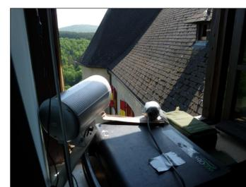
Abb. 10 Infrarotkamera mit Ausrichtung auf die Ausflugsöffnung der Wochenstube
